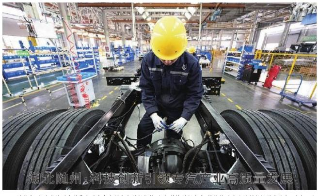
近年来,湖北省随州市引导专用汽车发挥自主创新优势,加大科技创新力度,持续推动产业链创新链深度融合,助力工业经济高质量发展。目前,当地的专汽企业研发生产的油罐车、洒水车、清障车等多个单项品种热销全国。图为工人在新能源商用车底盘装配线上作业。 新华社记者 肖艺九 摄
