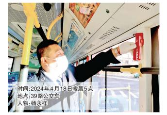
4月18日凌晨5点钟,39 路公交司机杨永祥已经骑自 库,开始对自己驾驶的39路 公交车进行日常"三检"中的 发车前检查,对灭火器安全 锤等安全设施、电器电路、制 动系、转向系、车身、车厢、驾 驶区以及附属设施等一一认 真检查,确保没有任何问题 之后,又对车厢内外进行卫 生清理。
