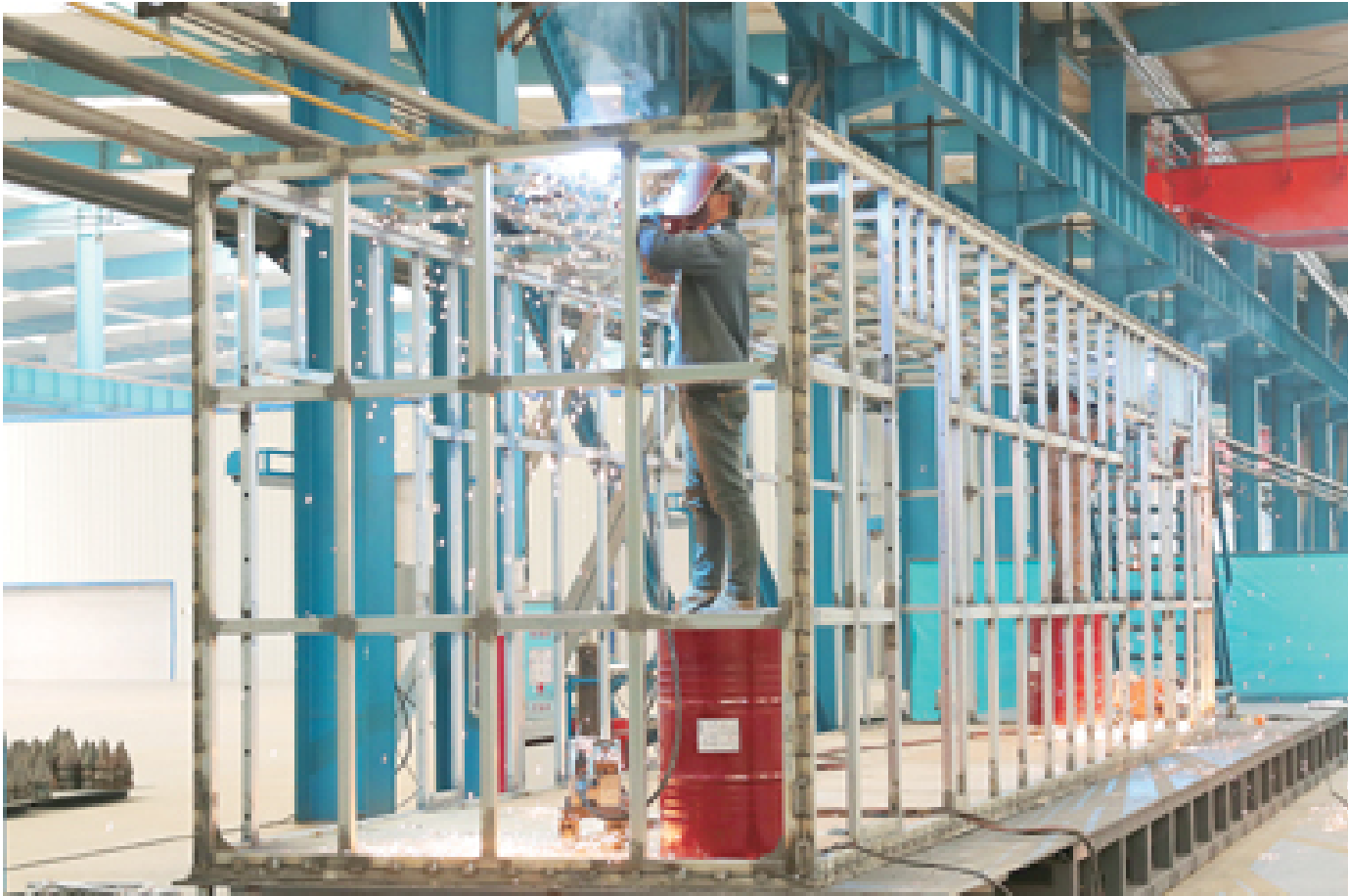
辽源市汽车改装有限公司二〇二〇年共生产移动(核酸)微生物检测车四十八台,除提供给吉林省疾控中心、吉林省人民医院、吉大一院和二院及三院外,其他外销新疆阿勒泰地区、黑龙江、辽宁等地,积极助力当地疫情防控工作。今年,该公司预计生产移动(核酸)微生物检测车一百二十台,以满足本省及兄弟省市常态化疫情防控的需求。图为企业员工在焊接微生物检测车车体框架。
