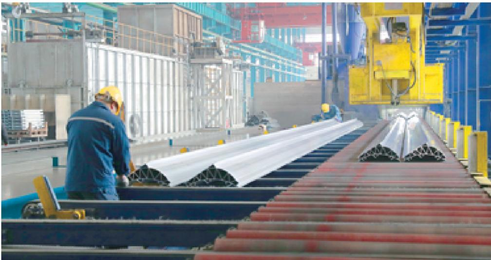
启星铝业是我国轨道交通车辆铝合金车体材料专业生产企业,产品大批出口到欧洲、北美洲、南美洲等十多个国家和地区。该公司主导产品轨道交通车辆铝合金型材、车体大部件、零部件的国内市场占有率在百分之五十以上,国内出口份额在百分之九十以上。图为该公司挤压车间工人正在生产轨道交通车辆铝合金型材。本报记者 夏景明 摄
