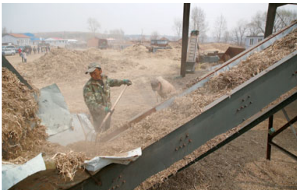
吉林省景辉家庭农场有限公司的秸秆颗粒加工生产线,工人正在将秸秆加工成秸秆生物质燃料颗粒。 本报记者 魏利军 摄
