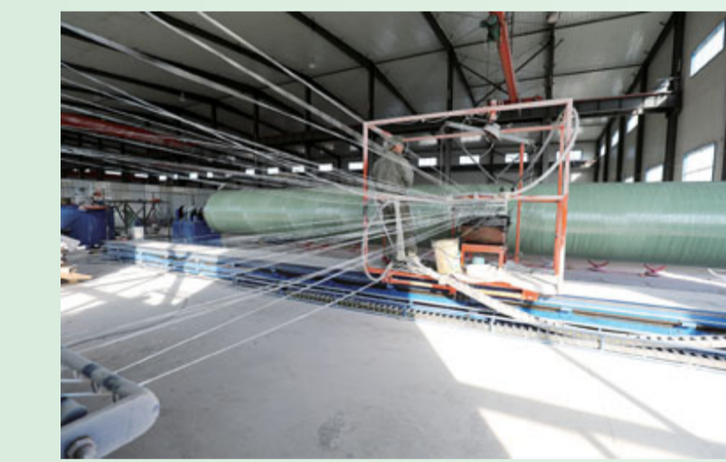
▲“厕所革命”是改善农村人居环境整治当中的重要工作。在龙山区工农乡冶村的福阳环保科技有限公司的罐体生产车间,一派热火朝天的劳动景象。上料、切割、装车,忙而不乱、井然有序,龙山区农村户用厕所改造所用的室外装配式堆肥早就是这里生产的。它结构简单坚固、实用,一体化设计,地下部分无接头,强度高、耐腐蚀、抗老化性强,冬季气温低冻不坏,能保证50年不渗漏,添加微生物除臭降解菌剂后,厕屋无臭味,粪便降解快,罐体底部超过土地冻层,冬季不会上冻,能保证农户正常使用。
